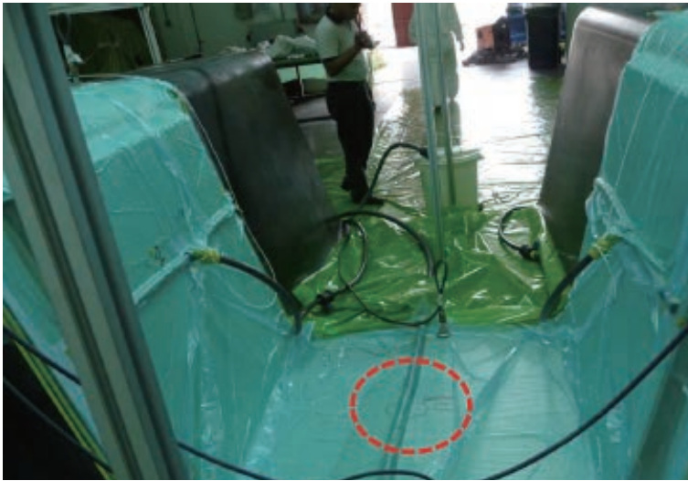
硬化センサ6個使用(構造物の真空注入試験)パーツ寸法 3×2×2m
