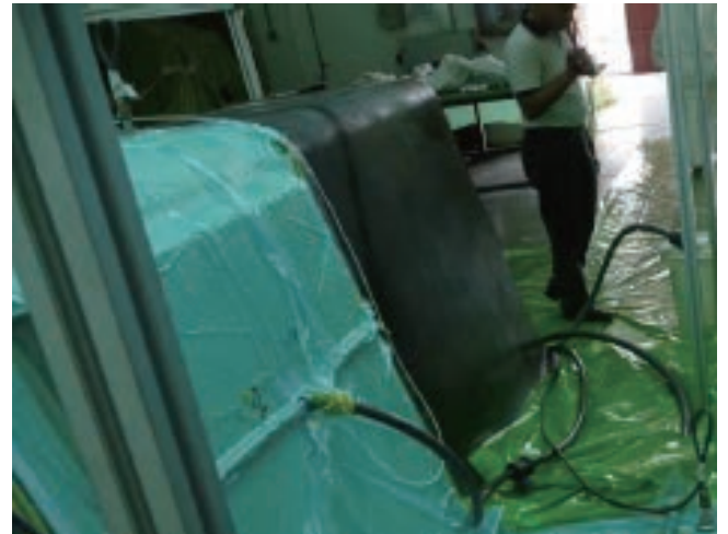
複数のOptiMold、OptiFlowユニットを用いて多点で樹脂到達、粘度変化・硬化進行、温度等のリアルタイム測定
